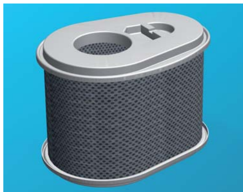
Partikel/Gasfilter Art.nr: FHC 50 Ett två stegs filter som filtrerar damm och rök med ett sk. HEPA-filter följt av ett aktivt kolfilter för avskiljning av gaser och lukter.
